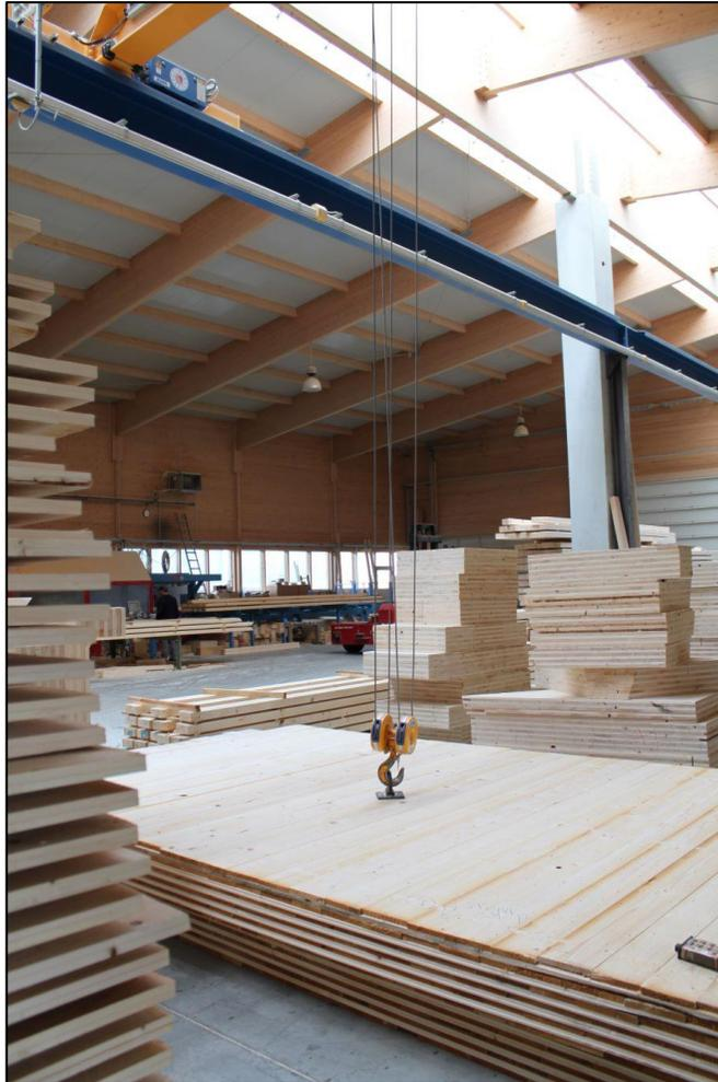
Компания "Амурский Берег" реализует проект по производству готовых домокомплектов по технологии ускоренного строительства с применением щитов из хвойных пород дерева. В её основе – щиты из хвойных пород дерева стандартных габаритов 3\*6 м, соединенные без клея.
